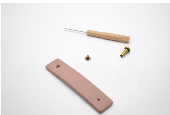
33. We monteren het label over de rand van de mand. Zet vast met de schroefbare klinknagel.
